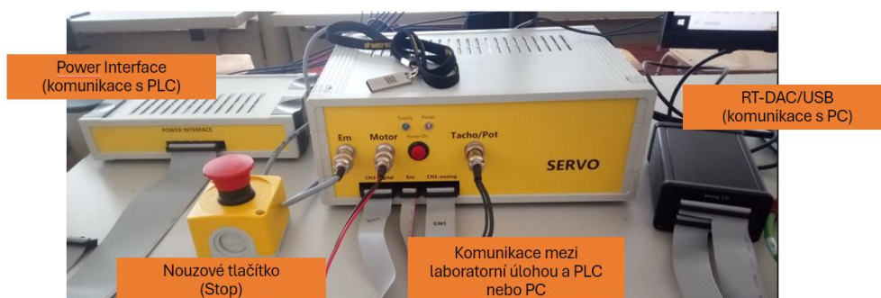
Obr. 2 – Sestava servopohonu – zařízení pro komunikaci s PLC, zdroj autor
